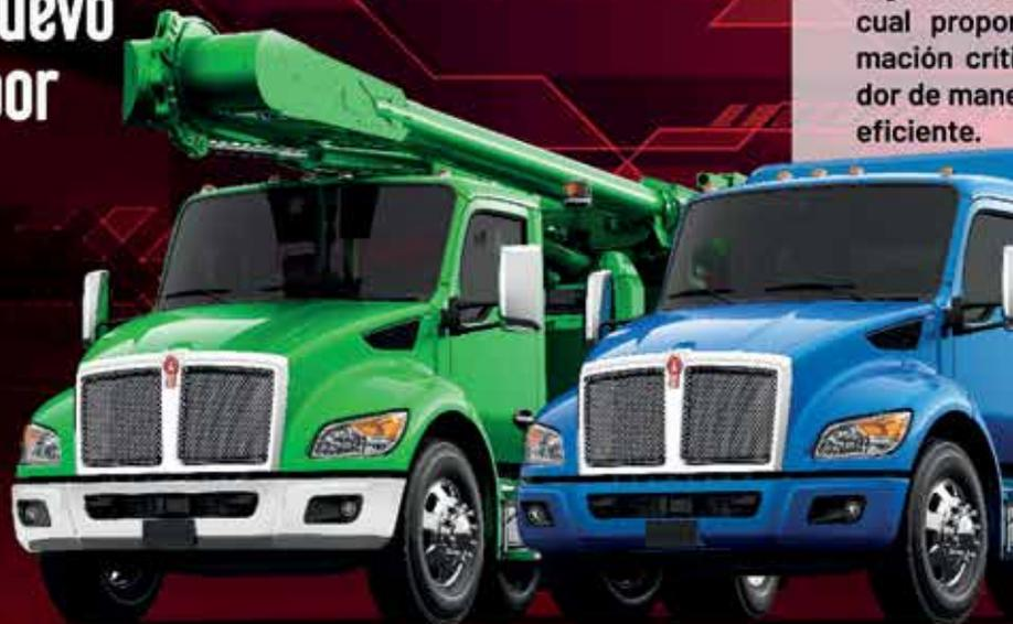
La configuración del nuevo T380 y T480 es muy variada por su versatilidad. Viene con motor PACCAR PX-7 o PX-9, transmisión manual 6, 9 y 10 velocidades o automática de 5 y 6 velocidades. El modelo T380 configuración con eje frontal hasta 14,600 libras y eje trasero hasta 40,000 libras o el modelo T480 con eje frontal de 20,000 libras y/o eje trasero de 46,000 libras. Frenos Bendix y nuevo tanque de combustible de hasta 80 galones, entre otras características.
