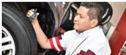
pes o malformaciones. 4.- Observe el nivel de desgaste de la banda de rodadura. En caso de detectar cualquier desperfecto en las llantas o de encontrar un desgaste irregular será necesario cambiarlas.
